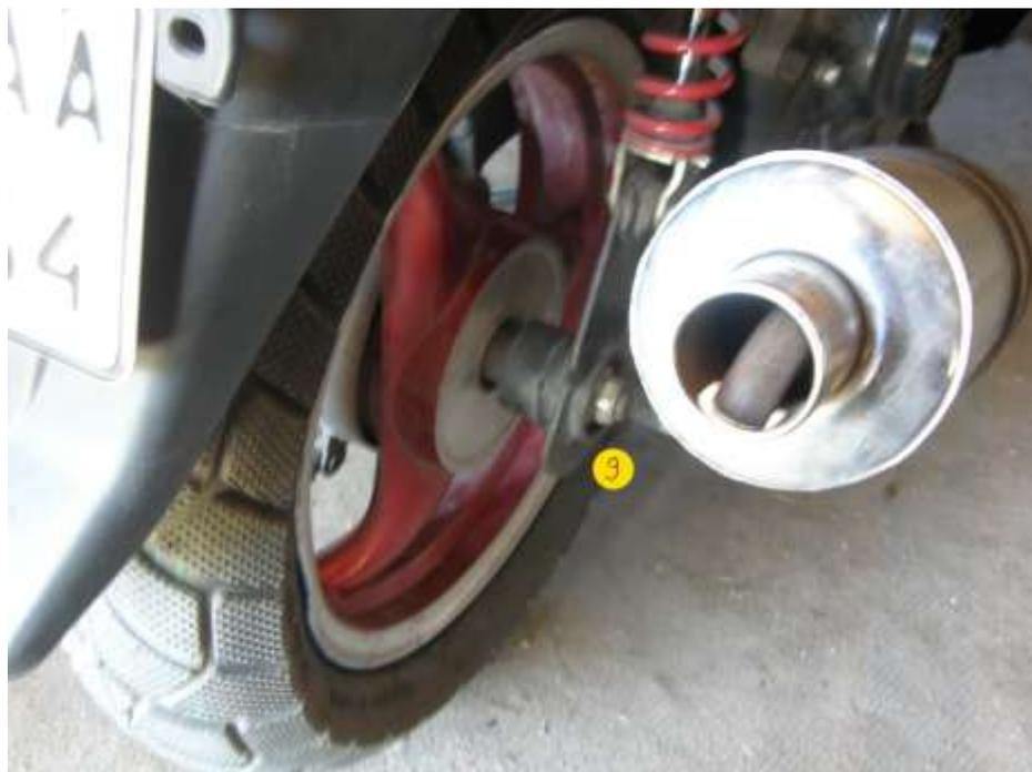
Разборка узла крепления колеса к раме гайкой п.9 производится в такой последовательности:
