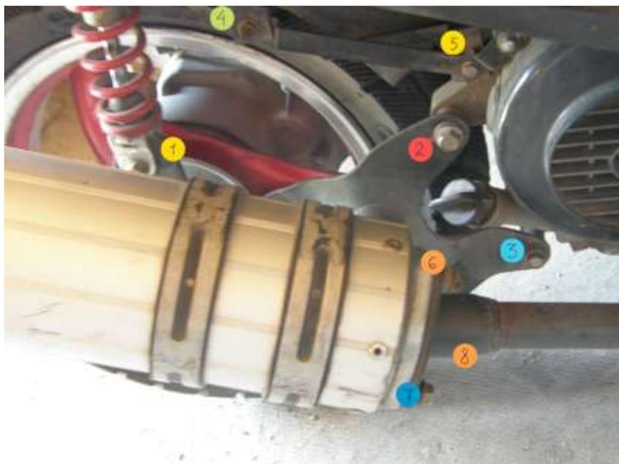
Цифрами обозначены болты которые нужно открутить перед снятием.
