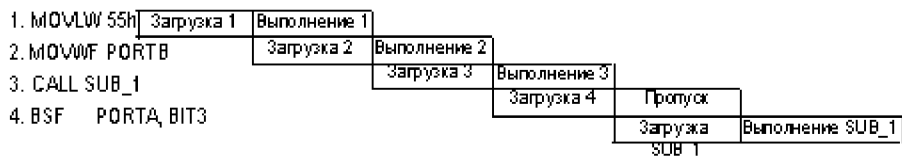
Рисунок 2.1. Схема тактування і виконання команди
